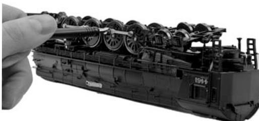
Dann entfernen Sie das Kunststoffteil mit den Bremschuhdetails; spreizen Sie das Teil vorsichtig, ziehen es noch oben und legen Sie es beiseite. Entfernen Sie die 5 Schrauben, welche die rechteckige Bodenplatte befestigen. Entfernen Sie die Bodenplatte und die 2 Schrauben, die den Getriebedeckel befestigen. Halten Sie an dieser Stelle inne. Führen Sie die weiteren Arbeitsschritte erst aus, wenn Sie den folgenden Arbeitsschritt gründlich studiert haben.
