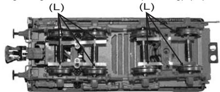
Das Getriebe der Lokomotive wurde bereits beim Hersteller geschmiert und benötigt kaum Wartung. Leistet die Lokomotive jedoch übermäßig viele Betriebsstunden mit hoher Zuglast, empfiehlt es sich, die 2 Schrauben des Getriebedeckels zu entfernen und das Getriebe mit M.T.H. Getriebefett oder einem gleichwertigen Produkt zu schmieren.
