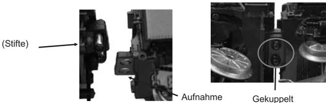
Die HO S 3/6 ist mit der neuen kabellosen, kurzgekuppelten Deichsel ausgestattet! Um die Lokomotive mit dem Tender zu verbinden, setzen Sie lediglich die Stifte der Deichsel gemäß obiger Abbildung in die Aufnahme.
