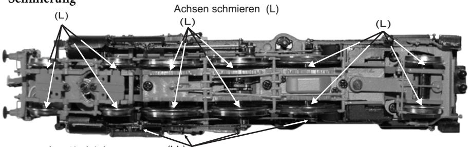
Verwenden Sie leichtes Nähmaschinenöl und tragen Sie es auf alle Treibstangen, Gelenke, Achsen und anderweitige beweglichen Teile kleine Mengen Schmierstoff auf (siehe Abbildung).
